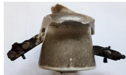
A letört KD szigetelő tartószerkezeten maradt darabja és a leesett darab
